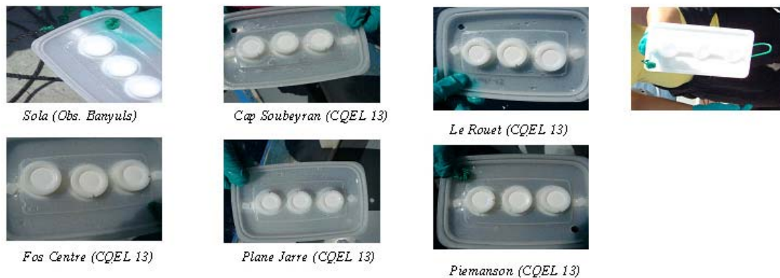
Figure 11 : Exemples de l'état de surface de DGT après immersion (de l'ordre de 48 h) dans différentes stations (Gonzalez et al. , 2009).
