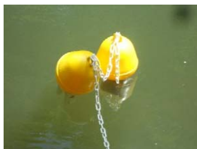
Figure 68: Système de déploiement de type « bouée » privilégié pour les grands cours d'eau
