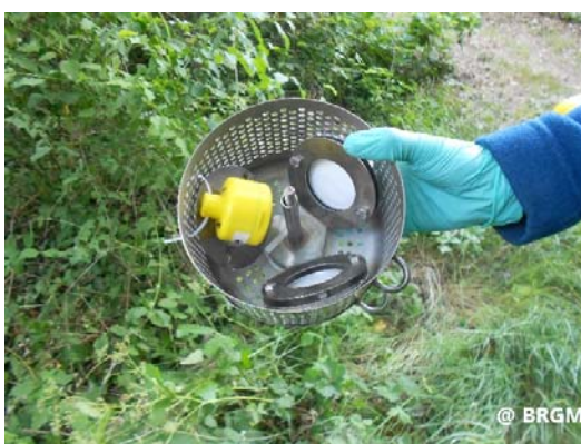
Figure 3: Photos du système d'exposition des POCIS du BRGM, un canister inox Exposmeter.
