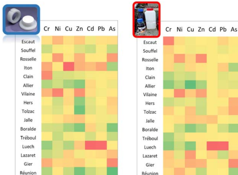
Figure 51 : Heatmaps des sites de l'approche multi-sites élaborée à partir des concentrations mesurées par DGT et par prélèvement ponctuel pour Cr, Ni, Cu, Zn, Cd, Pb et As.
