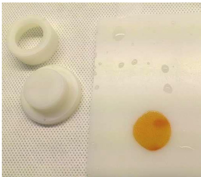
Figure 2 : Démontage d'une DGT de type ferrihydrite.
