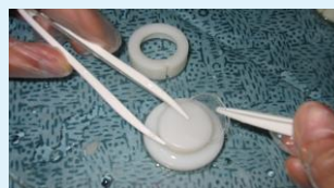
Figure 3. DGT en cours de montage.
