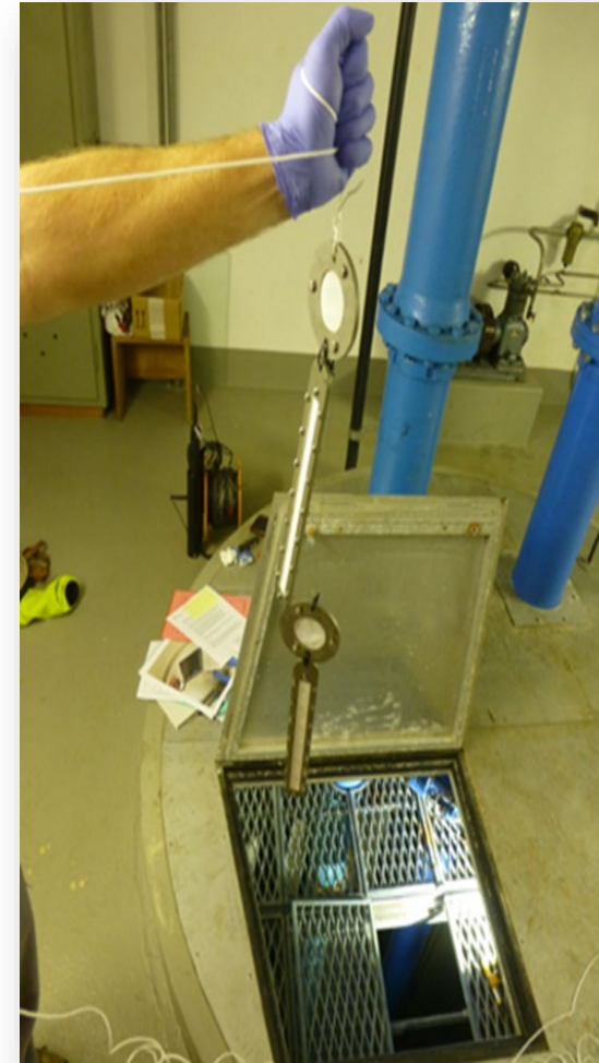
Fixation des EIP sur une chaîne pour exposition en piézomètre
