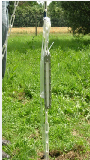
Fixation des EIP sur une chaîne pour exposition en piézomètre
