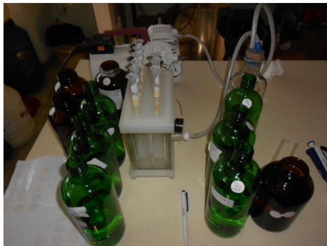
Illustration 1 : Etape d'extraction des eaux sur cartouche
