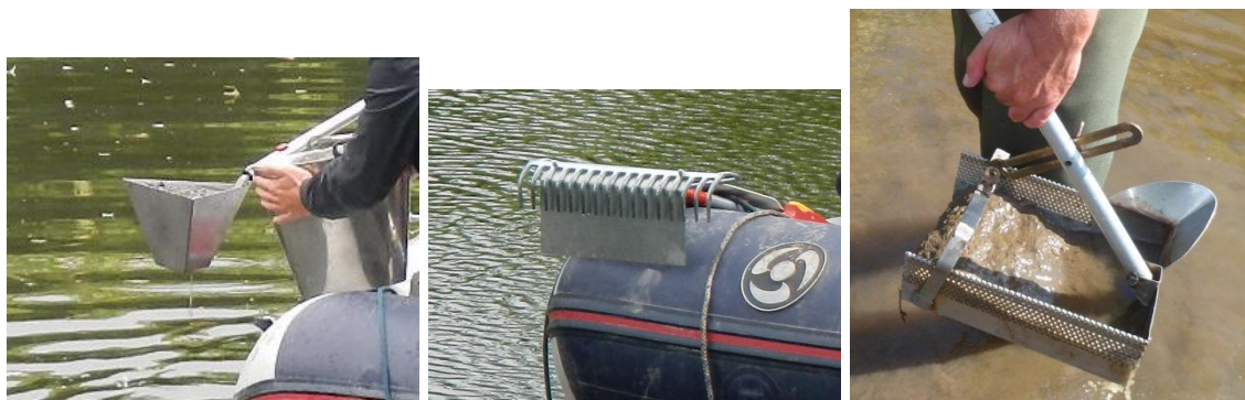
Figure 7 : Matériels d'échantillonnage "fait-maison" (de gauche à droite) : pelle inox triangulaire, pelle râteau avec manche gradué, drague type Cemagref
