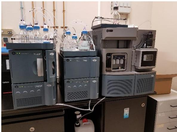
Illustration 2 : Analyseur SPE en ligne couplée à la UPLC-MS/MS (2D) en mode d'ionisation Unispray
