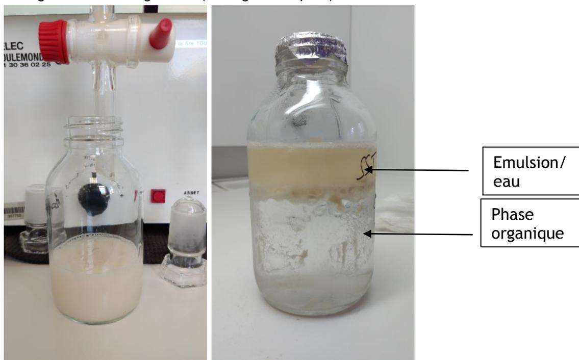
*Figure 1. Echantillon d'eau synthétique de rejet après extraction (gauche) et après congélation/décongélation (droite)*
