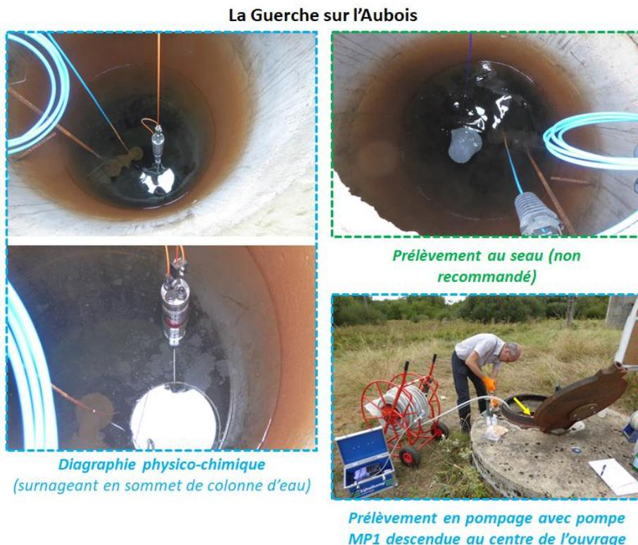
Figure 16 : station de La Guerche sur l'Aubois : aperçu des actions menées sur site (diagraphie dans la colonne d'eau, prélèvement au seau et pompage) ; la flèche jaune indique le point de référence utilisé pour la mesure des niveaux d'eau dans l'ouvrage.
