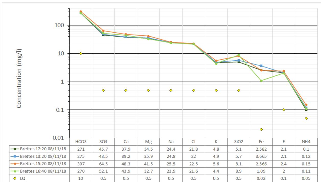
Figure 62 : station de Brettes : analyses chimiques sur éléments majeurs (en mg/L ; ne sont pas représentés les éléments inférieurs à la limite de quantification : NO<sub>2</sub><0,01 mg/L ; NO<sub>3</sub><0,5 mg/L ; PO<sub>4</sub><0,05 mg/L ; CO<sub>3</sub><10 mg/L).
