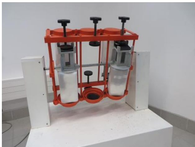
Figure 2 : Système d'agitation rotative utilisé pour l'équilibrage et l'homogénéisation lors du dopage des sédiments naturels.
