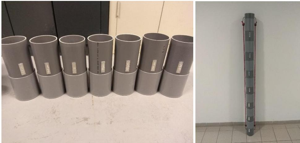
Figure 4 : Sections du piège GEACOS démontées et assemblées avant déploiement.
