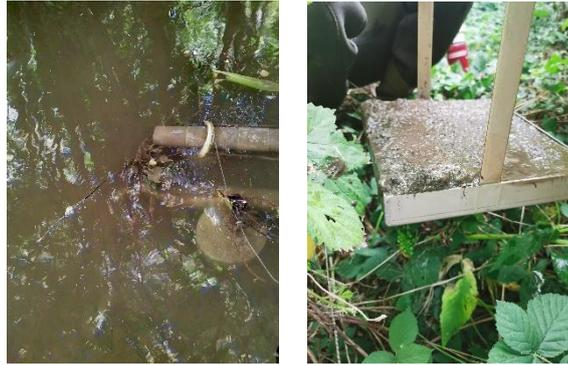
Figure 9 : Photo de débris végétaux piégés au niveau des trous d'entrée et sortie des pièges GEACOS (GEC) et Phillips (PHI) et bac du piège à particule de type OSR (PT100) rempli de MES.
