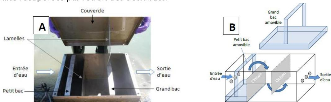
Figure 1 : Présentation du piège à particules : (A) photo d'un piège à particules ; (B) schéma de fonctionnement (d'après Gruat et al. 2022, outils opérationnel ZABR<sup>2</sup>).
