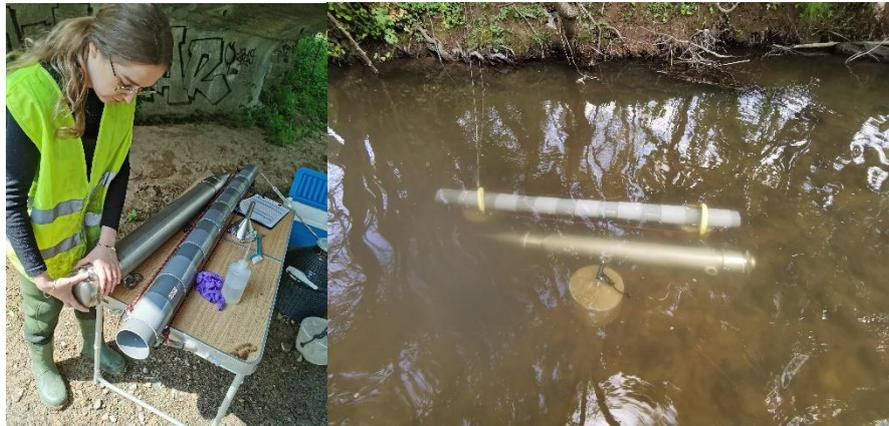
Figure 7 : Préparation des pièges sur le site du pont de Pizay sur l'Ardières et photographie du GEACOS (GEC) et du Phillips (PHI) déployés dans l'Ardières.
