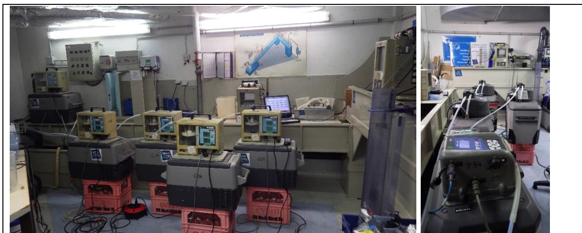
Figure 2 : Mise en œuvre des échantillonneurs PAV sur le banc d'essai de l'Agence de l'Eau Rhône Méditerranée Corse
