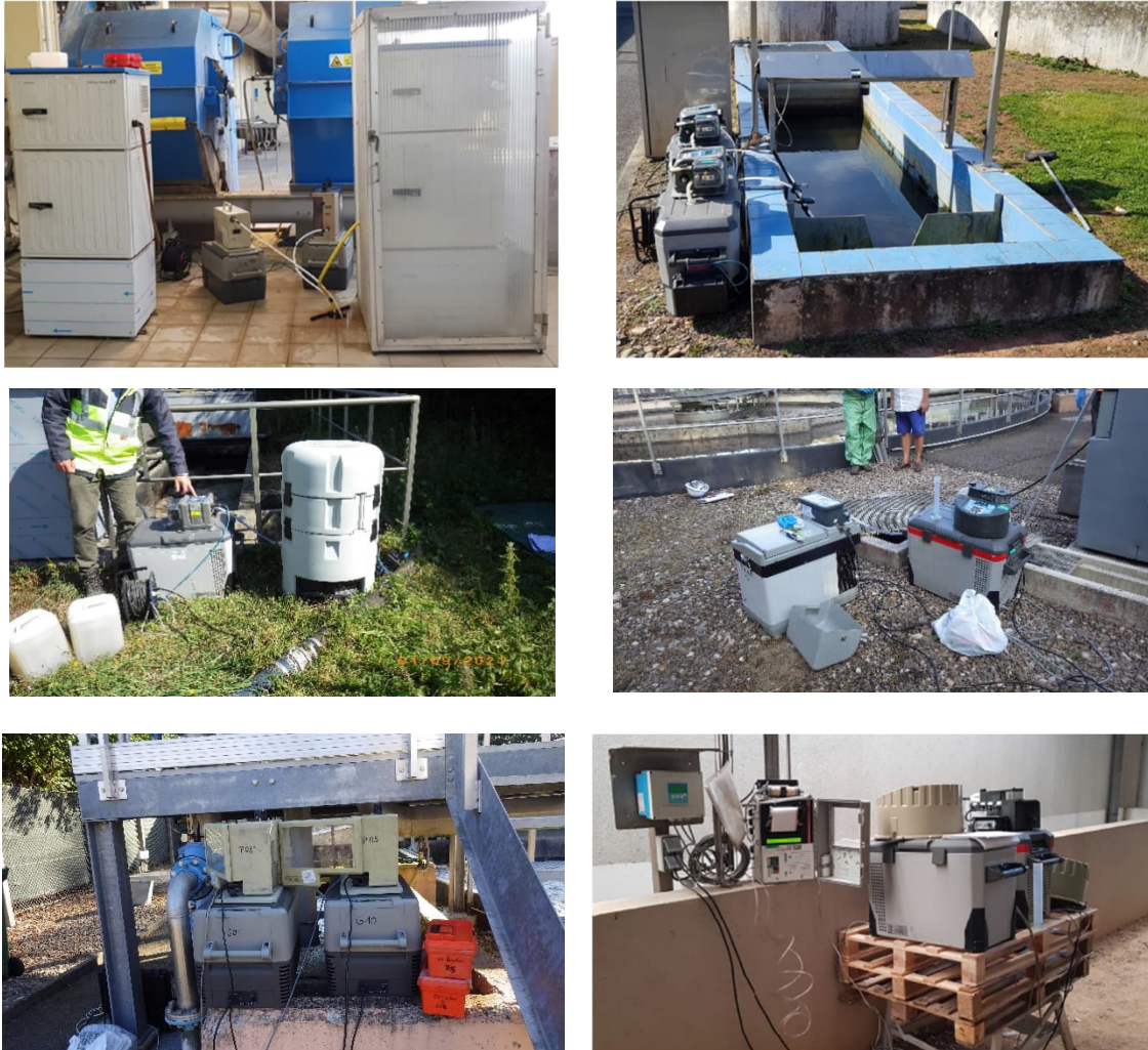
Figure 10 : Photos de doubles échantillonneurs installés sur site par les intervenants préleveurs, à gauche en eau d'entrée et à droite en eau de sortie de station d'épuration
