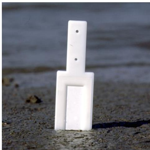
**Figure 3 : Photo d'une sonde DGT insérée dans le sédiment (Lancaster)**
