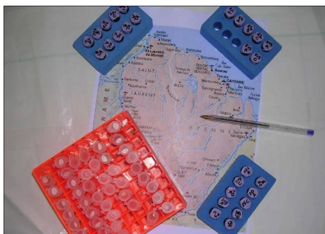
Figure 28. Échantillons DGT et SBSE (10 stations) prêts pour l'analyse après conditionnement sur place lors de la campagne de 2010 en Guyane (Source : Gonzalez et al. , 2012c).
