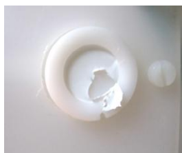
Figure 25. DGT dont une partie du filtre de protection a été endommagée à l'Ilot Choizil, Mayotte (Source : Gonzalez et al. , 2012b).
