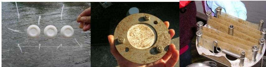
Illustration 1 : exemples d'échantillonneurs passifs : DGT, POCIS et SPMD (de gauche à droite)
