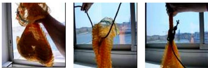
Fermer le sac lesté et le fixer avec environ 1 à 2 m de bout de la ligne de mouillage.
