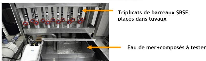
**Figure 2 :** Banc SBSE développé par le CEDRE.
