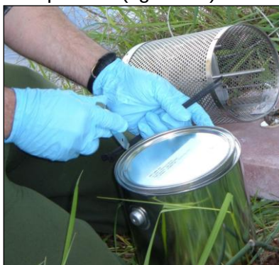
Figure 11 : Illustration du desserrage du couvercle de la boîte contenant la SPMD (décapsuleur dans la main droite, attache autobloquante dans la main gauche). (Illustration d'après ECY)
