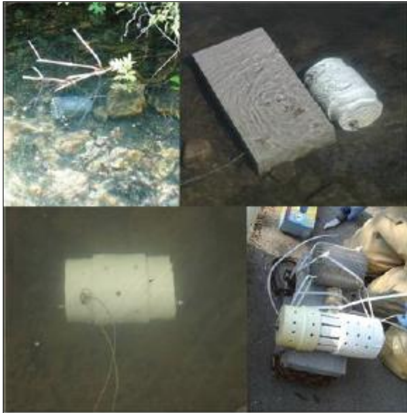
Figure 6 : Exemples de système d'accrochage/d'arrimage en eau peu profonde (Photos d'après USGS)
