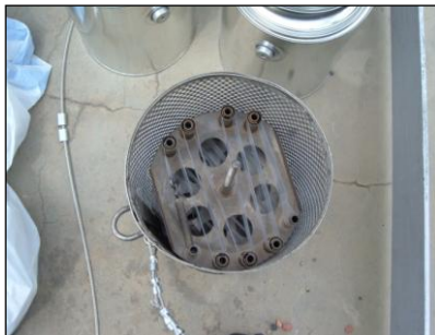
Figure 13 : Illustration membranes SPMD à l'intérieur d'un canister. (Illustration d'après ECY)
