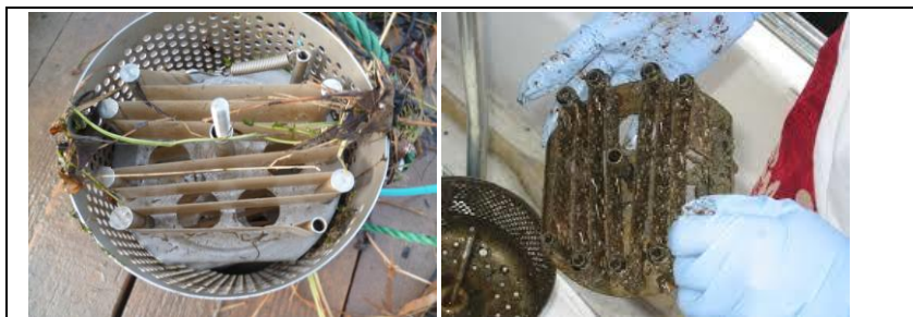
Figure 9 : Illustration SPMD post déploiement : macro-déchets et macro-organismes
