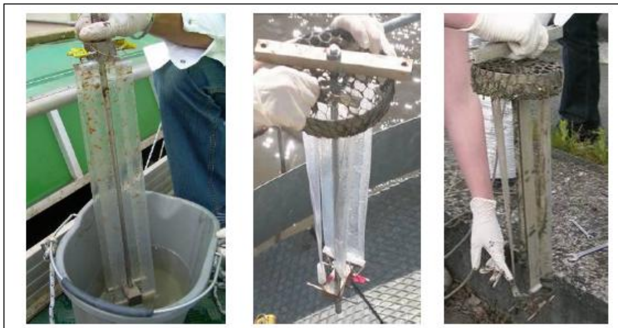
Figure 7 : Exemples de système de déploiement dans des milieux protégés (Photos d'après IRSTEA)
