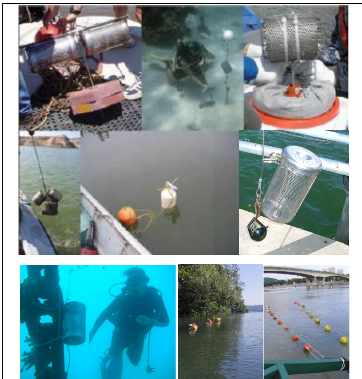
Figure 4 : Exemples de systèmes d'attache (Photos d'après USGS)
