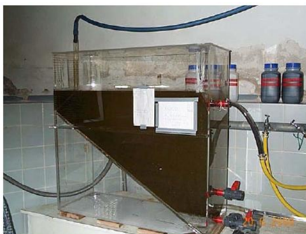
Figure 11 : Photo et schéma du système de décantation des particules de type ARGE Elbe (d'après Heininger et al., 2002) [36].
