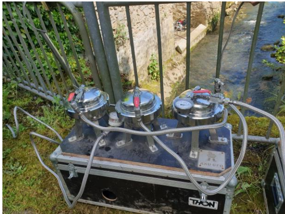
Système de filtration développé par l'Université d'Aalborg
