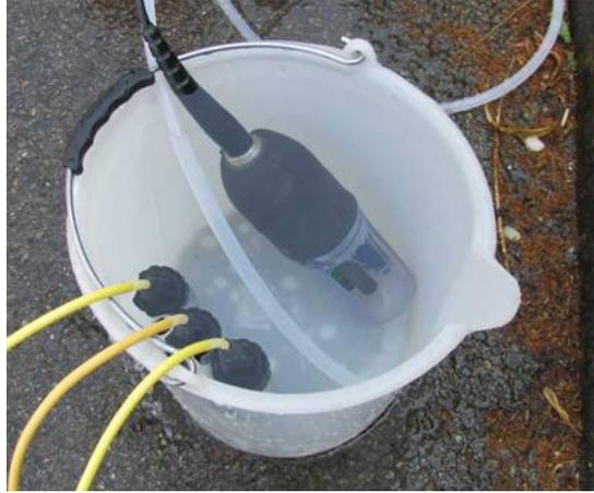
Figure 21 : Mesure des paramètres physico-chimiques dans le seau de débordement
