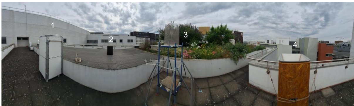
Figure 3 : Collecteurs de microplastiques atmosphériques utilisés pour l'étude métrologique collective, de gauche à droite : (1) collecteur du LISA, (2) collecteur de l'IMT-Lille, (3) collecteur de l'université de Poitiers, (4) collecteur du LEESU
