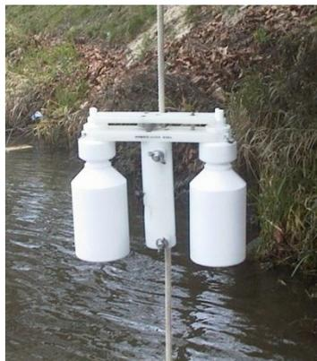
**Figure 2 :** Bouteille à prélèvement Merkos (Hydro-bios, Allemagne).
