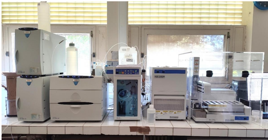
Figure 2 : module de combustion et de chromatographie ionique de la chaîne de mesure AOF
