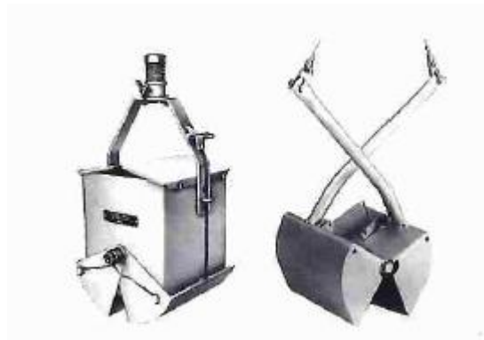
Figure 2: Bennes de type Eckman (à gauche) et Van Veen (à droite)
