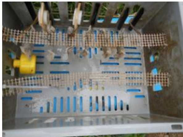
Figure 6. Exemple de dispositifs de déploiement DG en cours d'eau
