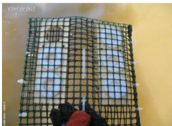
Figure 6. Exemple de dispositifs de déploiement DG en cours d'eau
