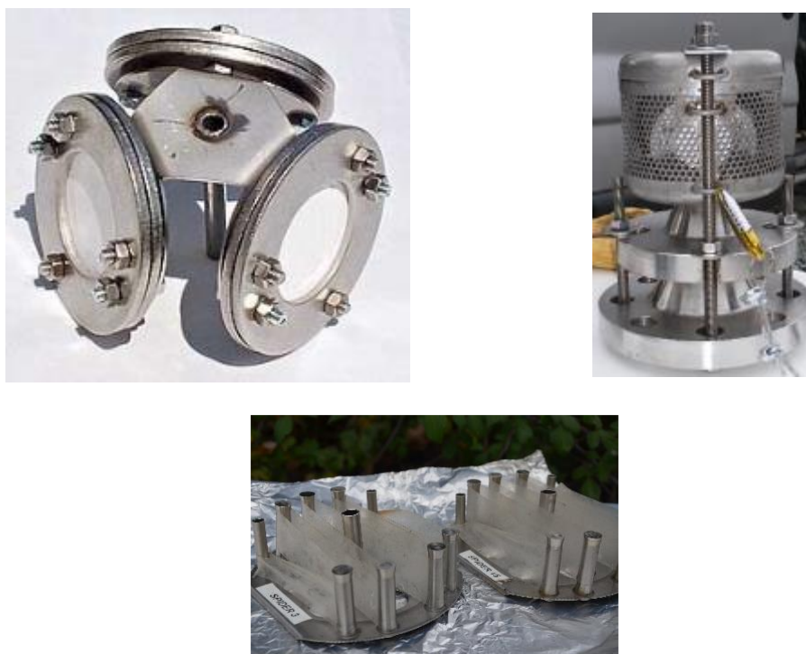
Figure 4. Dispositifs POCIS ( haut gauche)et SR (bas)
