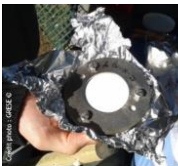
Figure 5. Illustration de conditionnement pour POCIS
