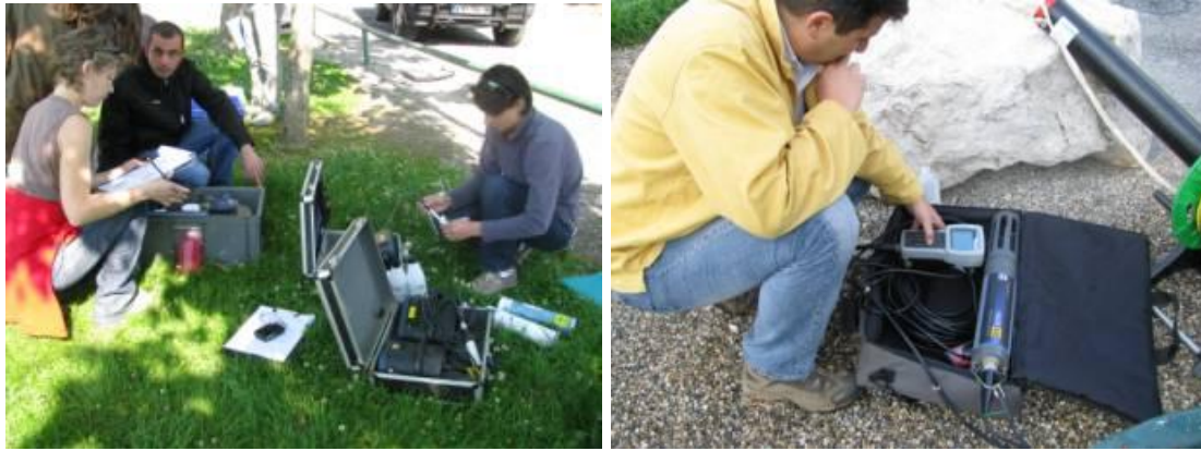
Figure 52 : Opérations d'ajustage des appareils de mesures des paramètres physico-chimiques sur les berges du lac de Paladru (Etapes 1, 3 et 5)
