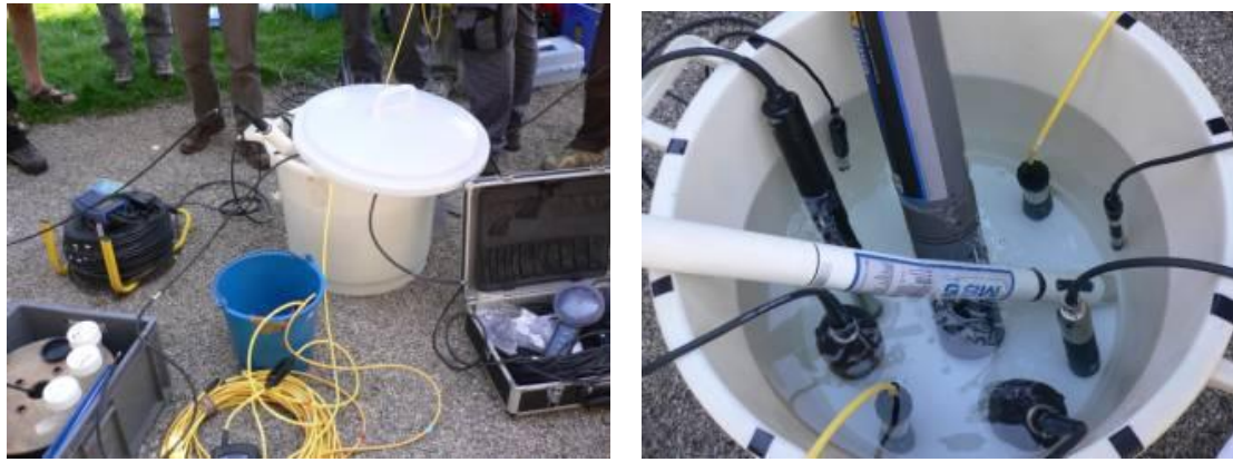
Figure 59 : Réalisation des mesures comparatives d'O 2 dissous dans une eau dont la teneur en O 2 a été abaissée
