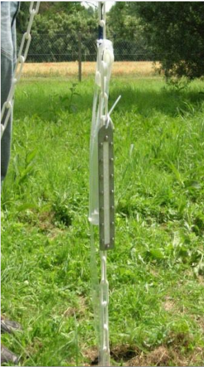
Fixation des EIP sur une chaîne pour exposition en piézomètre
