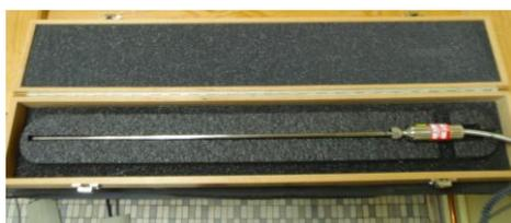
Figure 6 : Thermomètre à résistance de Platine Etalon Rosemount 162CE
