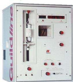
Figure 10 : Salinomètre Autosal Guildline
