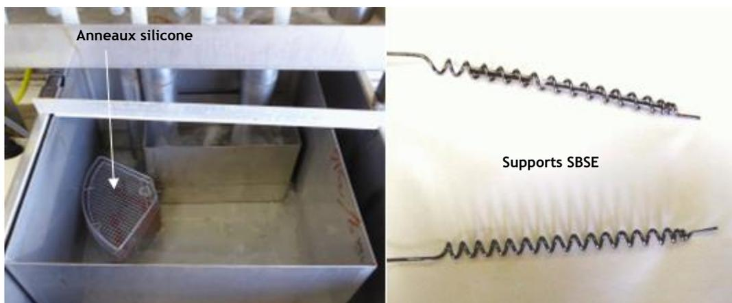
Figure 6 : banc SBSE avec les anneaux de silicone, et support pour barreaux SBSE
