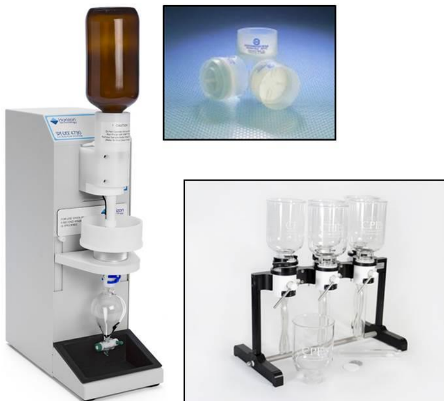
Illustration 1 – Exemples de dispositifs d'extraction en phase solide sur disque, automatisé (à gauche) ou manuel (en bas à droite).
