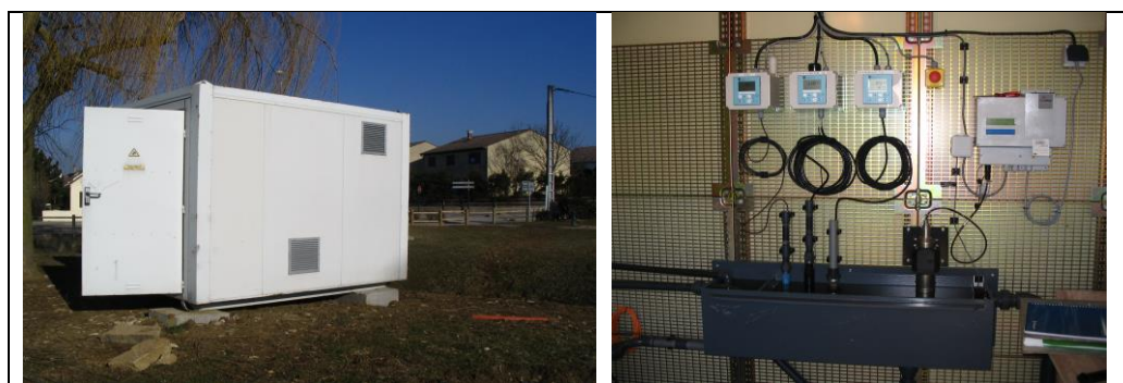
Figure 6 : Station en rivière de type on-line avec pompage et mesure dans un bac (d'après GEMCEA, 2009)
