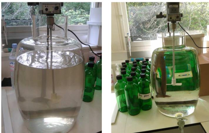
*Illustration 4 : Photographies de la cuve d'homogénéisation pour le remplissage des flacons pour l'eau chargée (à gauche) et l'eau peu chargée (à droite)*
