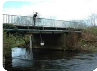
L'opérateur réalise le premier échantillonnage d'eau (A) à l'aide d'un intermédiaire (seau ou canne).
