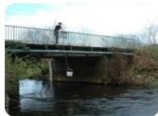
L'opérateur réalise un second échantillonnage d'eau (B) à l'aide du même intermédiaire (seau ou canne).
