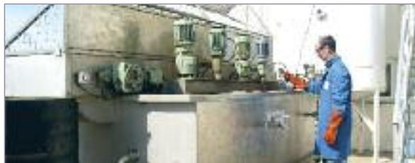
L'Office International de l'Eau dispose, sur son site de La Souterraine, d'un pilote de traitement de physico-chimique des eaux usées, permettant de former les professionnels aux techniques traditionnelles de coagulation/floculation, de flottation, d'élimination des pollutions azotées et phosphorées. Cette installation est couplée à une unité de traitement par boues activées d'une capacité de 500 équivalents-habitants.
