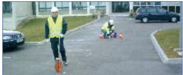
L'Office International de l'Eau dispose sur son site de Limoges de toute une gamme de matériels de détection de canalisation et de recherche de fuites représentant les principales technologies. Un réseau d'entraînement fuyard et enterré permet de former les professionnels aux différentes techniques de détection et de corrélation acoustique.
