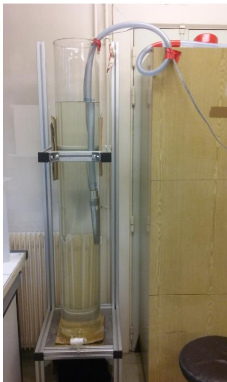
photographie 1 : éprouvette remplie d'eau contenant le matériel TRI au moment du prélèvement d'un échantillon.
