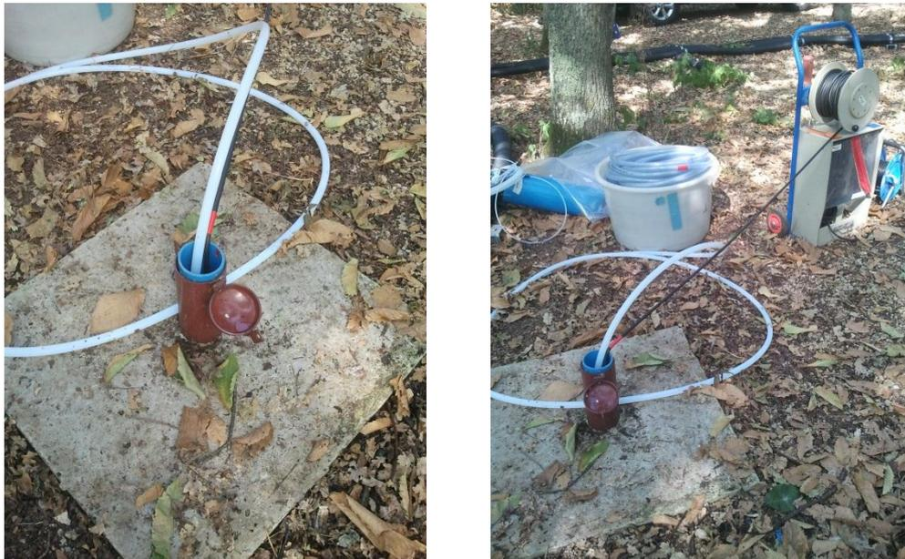
*Illustration 4 : Réalisation des essais d'échantillonnage avec un tuyau Téflon.*
