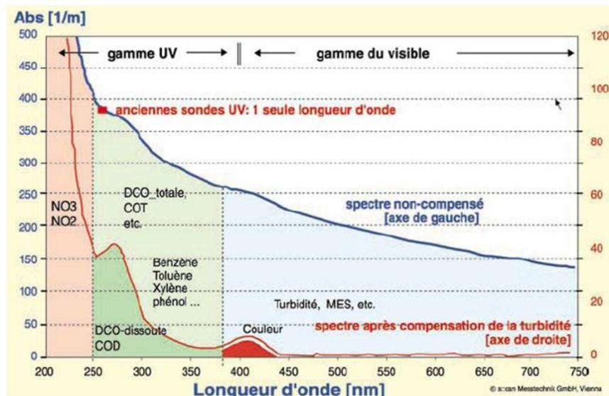
Figure 1 : Exemple de spectre UV-Visible d'une eau brute (ligne bleue), spectre après compensation de la turbidité (ligne rouge) et de paramètres tirés du spectre avec leurs profils d'absorbance caractéristiques (d'après van den Broeke et al., 2006).
