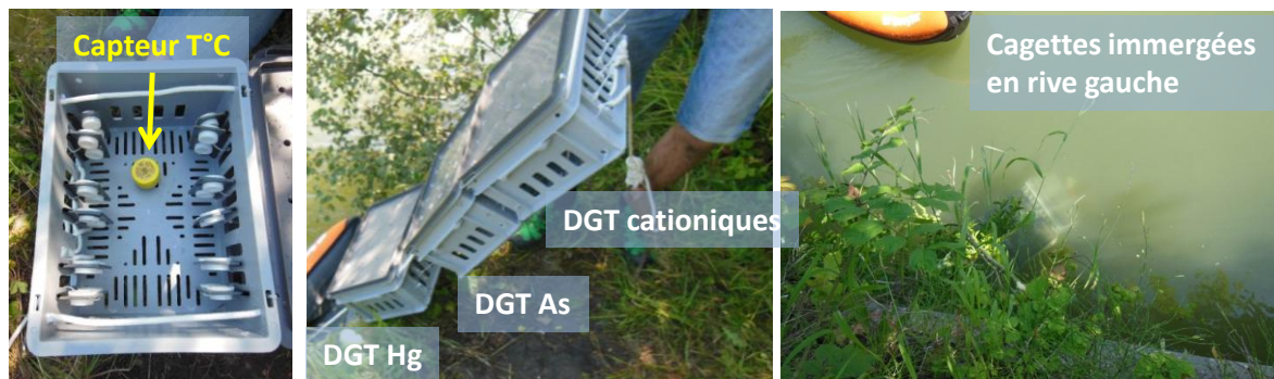
Figure 2 : Dispositif d'exposition des DGT (une cagette par type d'échantillonneur).
