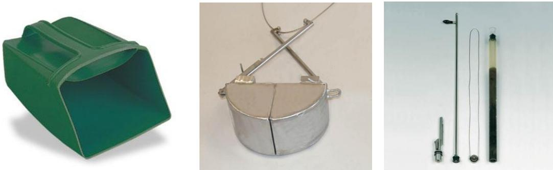
Figure 2 : Dispositifs pour l'échantillonnage de sédiment
