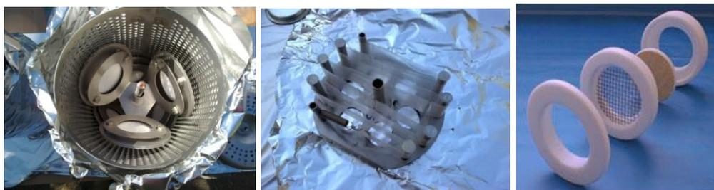
Figure 3 : Différents systèmes d'échantillonnage passif
