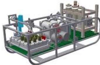
Figure 2: Différentes possibilités d'utilisation du module SBSE automatisé. A la différence de la version de surface, la version immergée a été conçue pour pouvoir fonctionner à des profondeurs <100m.
