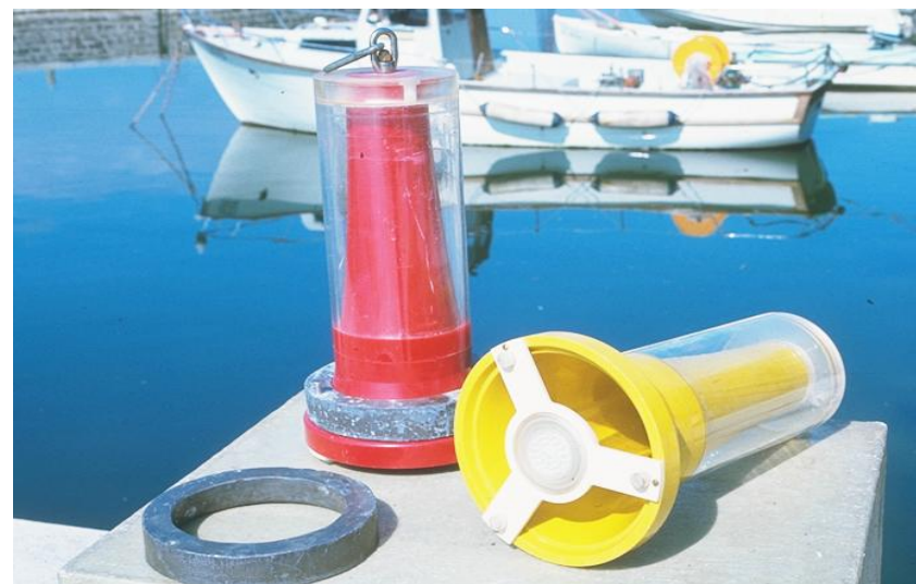
Bouteille de prélèvement intégré INRA (Pelletier & Orand 1978)
