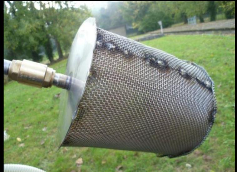
**Les premiers essais avec la pompe de surface furent concluants et une crépine constituée d'un clapet anti-retour et de grilles métalliques fut fabriquée**
