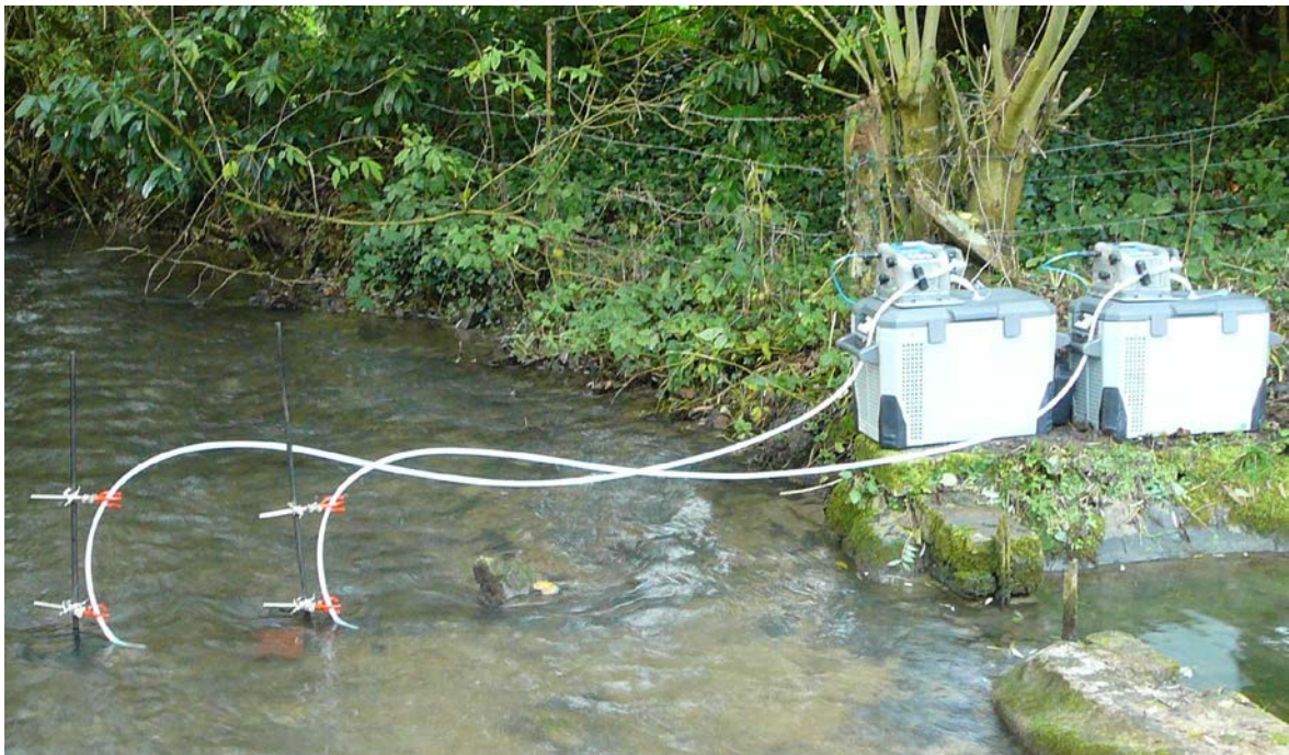
Figure 2 : Positionnement des préleveurs automatiques lors des essais
