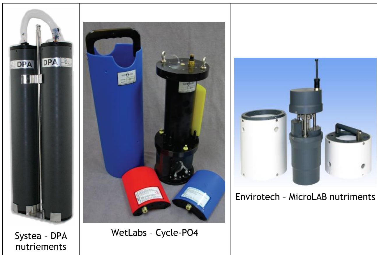
Figure 8 : Exemples d'analyseurs en ligne in situ
