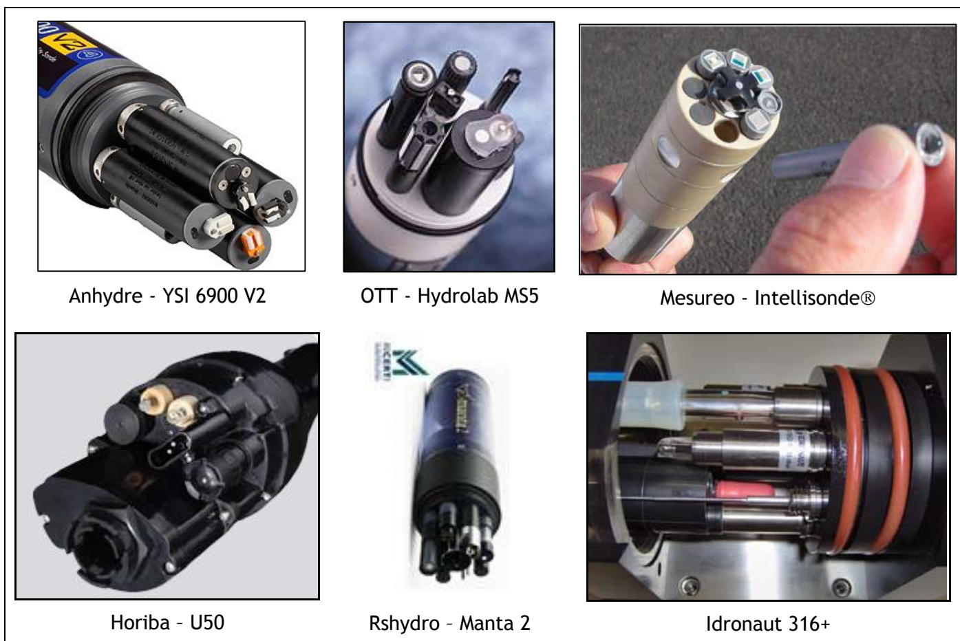
Figure 5 : Exemples de sondes multiparamètres
